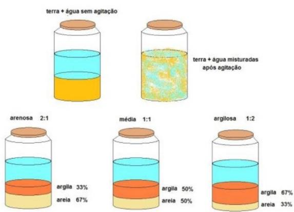
Em um frasco de vidro com tampa coloque um pouco do solo que você quer testar.
