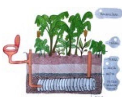
A Bacia de Evapotranspiração consiste em um sistema de tratamento de esgoto em que a água da descarga vai para uma manilha de pneus dentro de um tanque submerso todo impermeável, construído em ferro-cimento, preenchido como em um filtro, com pedras maiores em baixo, pedras menores no meio e solo fértil em cima, onde são colocadas plantas de folhas largas como
